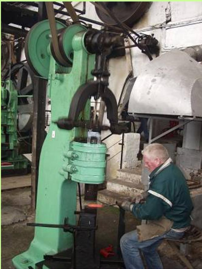
Der Federhammer arbeitet im Hammerwerk *Godthaab*. Die Wasserturbine zieht durch ein kompliziertes Raad- und Riemensystem sowohl die vielen Maschinen als auch die Gebläse der Schmiedefeuer. Das Hammerwerk ist völlig funktionsfähig, und es wird noch von Liebhabern geschmiedet.
